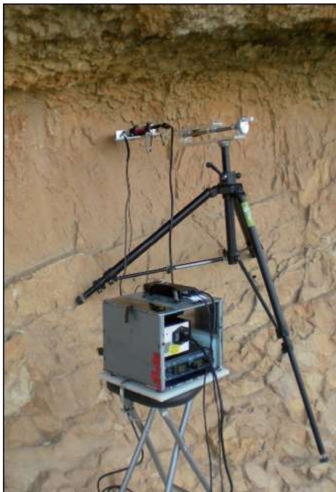
Figura 4 Espectrómetro portátil de EDXRF. Foto C. Roldán
